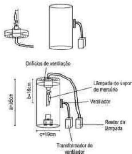
Figura 6. Representação esquemática do fotorreator<sup>9</sup>.
