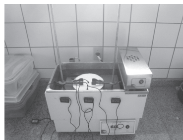
Figura 2. Sistema cilíndrico de transferência radial de calor por condução, inserido em banho termostatzado, com termopares acoplados.
