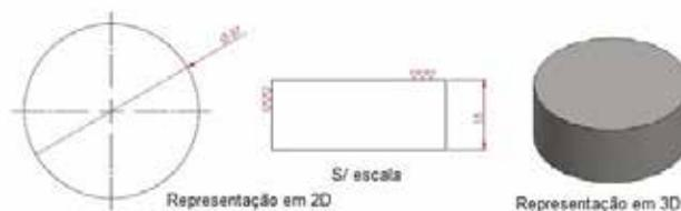
Figura 4. Dimensões do corpo de prova utilizado (imagens em 2 e 3D)
