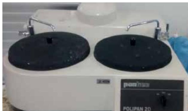
Figura 5. Lixadora/polidora PANTEC – Poliplan 2D
