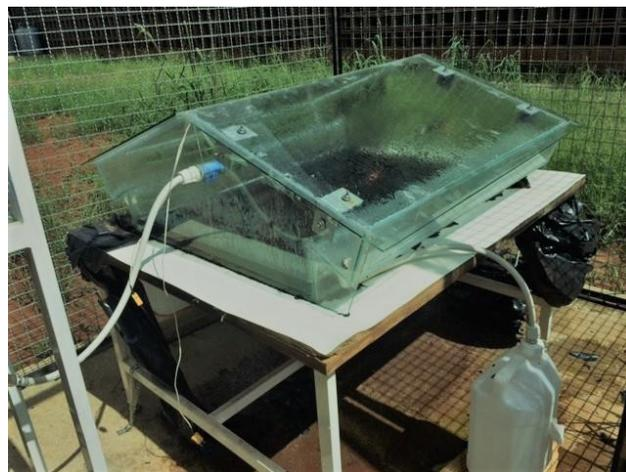
**Figura 8.** Fotografia da unidade piloto de destilação solar de água (Camila T. Damasceno) Coleta de temperatura da água e da cobertura no verão e no inverno.
