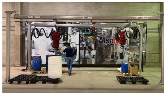
**Figura 1:** Sistema de movimentação a vacuo. Fonte: Autores.
