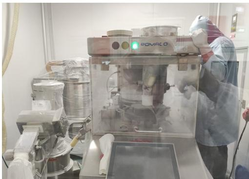
**Figura 6:** Sistema de enclausuramento e exaustão local nas máquinas. Fonte: Autores.
