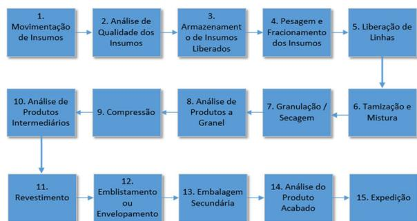
**Figura 1:** Processo de fabricação de formas farmacêuticas sólidas
