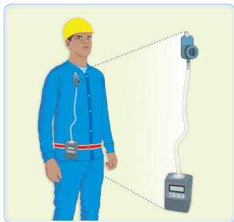
**Figura 2:** Exemplo de disposição da bomba de amostragem na zona respiratória do colaborador. Fonte: Peixoto, 2013,<sup>15</sup> p. 89.
